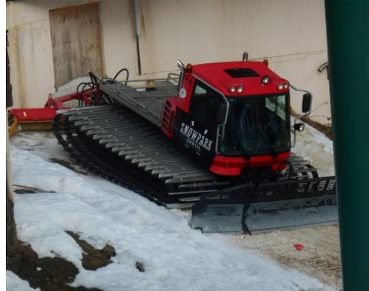
Un réservoir peut contenir 300 litres d'essence et utilise 35 litres par heure. Sur Châtel et les alentours, il y a 14 machines pour 21 chauffeurs et 3 mécaniciens. L'été les dameuses sont démontées puis remontées avec certaines pièces neuves.
